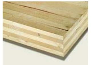
Bei den Brettsperrholzplatten dürfen zwischen den einzelnen Brettern in einer Lage Fugen auftreten. Die Bretter der einzelnen Lagen müssen keine seitliche Verklebung aufweisen. Diese Fugen sind herstellungsbedingt begründet. Die Breite dieser Fugen ist in der bauaufsichtlichen Produktzulassung mit 6mm begrenzt. Es gibt auch Plattenhersteller welche die Bretter der einzelnen Lagen auch seitlich verkleben.
