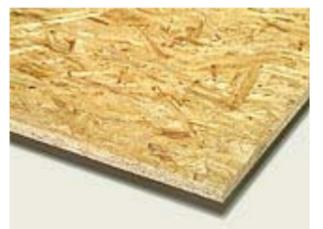
Der Einsatz als statisch tragendes Element hat in den letzten Jahren stark zugenommen. Vor allem werden OSB-Platten als aussteifende Beplankung bei Wänden, Decken und Dächern verwendet. Platten für statisch tragende Verwendung müssen den Anforderungen der EN 300 entsprechen.
