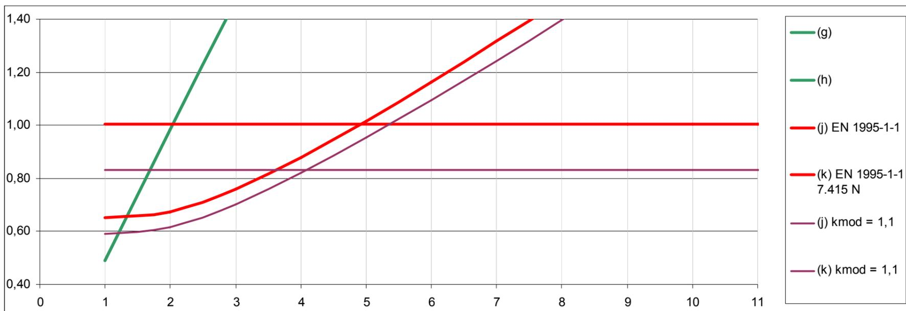
Verbindungsmittel:  $d = 12\text{mm}$ ,  $f_{u,k} = 800\text{N/mm}^2$ ; Holz 1: C24,  $t_1 = x \cdot d$ ; Holz 2: C24,  $t_2 = 2x \cdot d$
