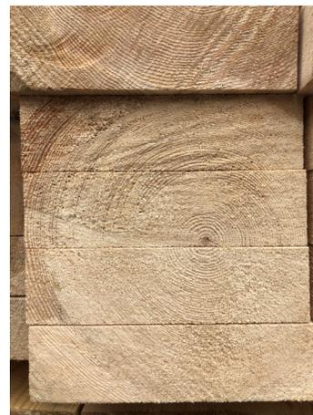
Abbildung 24 Schnittholz 7/26 cm direkt nach dem Einschnitt.
