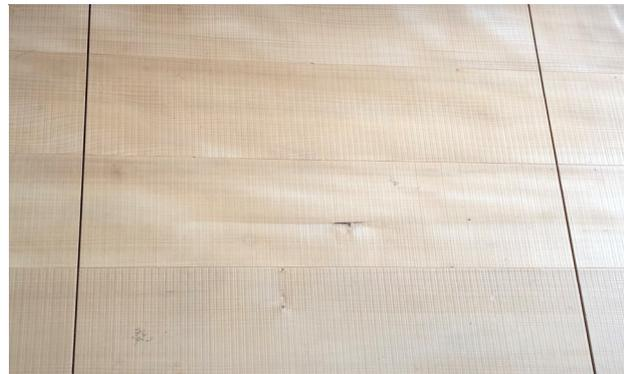
Abbildung 45 Spalten von getrockneten, gehobelten, Bohlen 60/140 mm mit der Bandsäge für den Balkonboden 29/140 mm.
