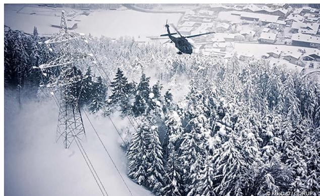
Abbildung 7 Um das Umstürzen von Bäumen auf Stromleitungen, Straßen oder die Oberleitung der Bahn zu verhindern werden Helikopter eingesetzt. Dabei setzen die Piloten gezielt den Luftstrom der Rotorblätter, den sogenannten Downwash ein, um den Schnee von den Bäumen zu blasen.
