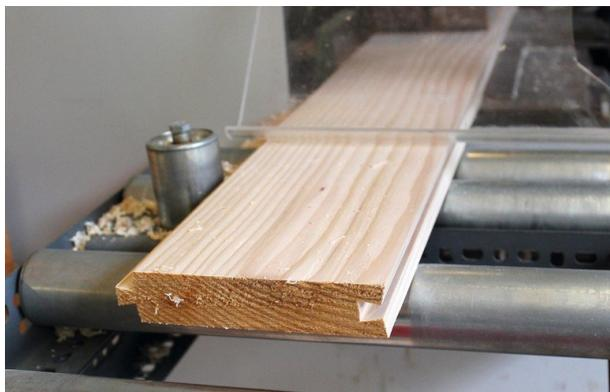
Abbildung 67 Einzelbrett 31 mm nach dem Fräsen, Massivholz Junker GmbH.
