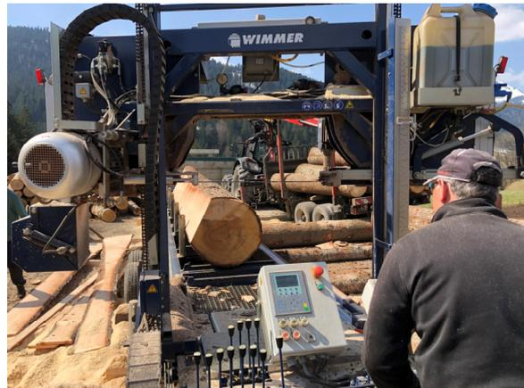
Abbildung 22 Mobile Blockbandsäge BN 110.
