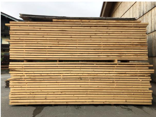
Abbildung 23 Gelattetes Holz im Holzbaubetrieb.
